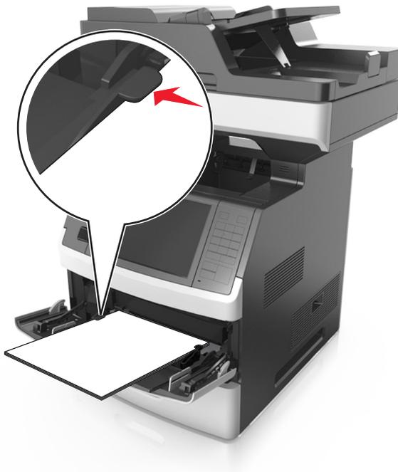
**6** 对于自定义或 **Universal** 尺寸纸张，调整宽度导片以轻轻地接触到纸张的边缘。
