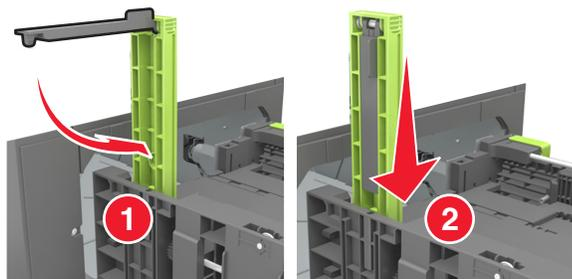
**d** 压住长度导片并将它滑动到与您加载的纸张尺寸相符的正确位置上。
