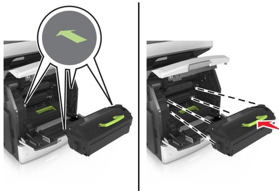
**警告—可能的损坏：**当更换碳粉盒时，不要让成像部件长时间暴露在直接的光线下。长时间暴露在光线下可能导致打印质量问题。
