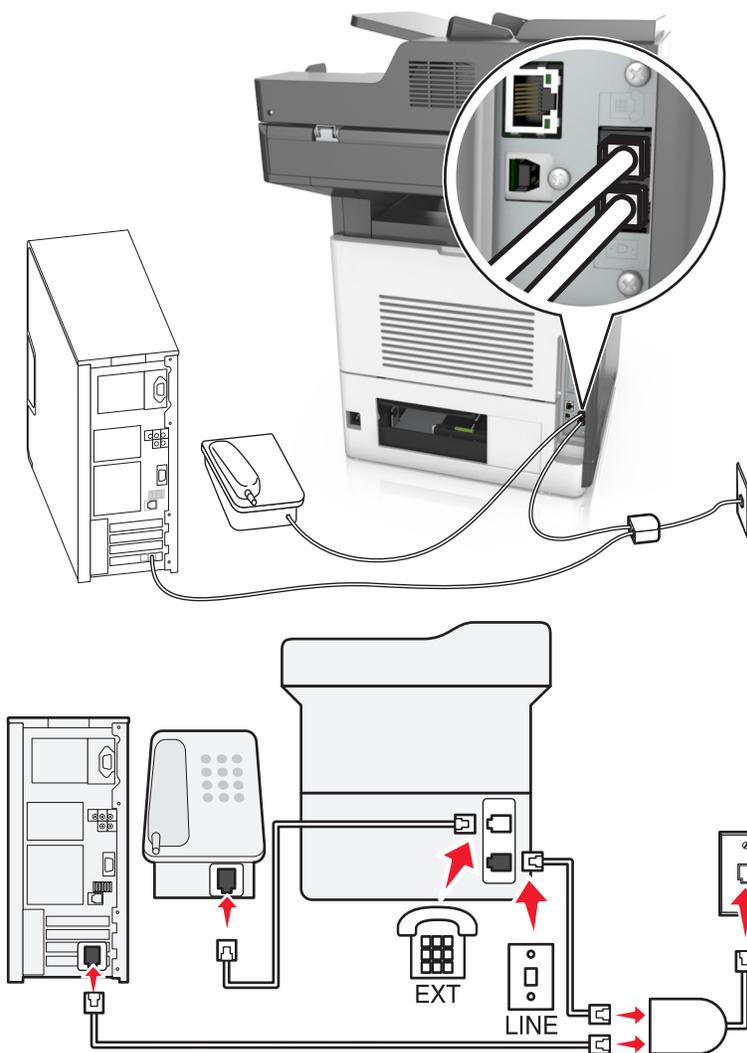
“数字用户线”将您的常规电话线路分为两个通道：语音和 Internet。电话和传真信号通过语音通道传输，而 Internet 信号通过另一个通道传输。这样，您可以使用同一条线路进行模拟语音呼叫（包括传真）和数字 Internet 访问。
